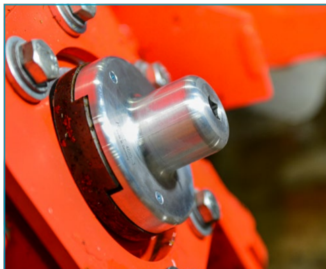
Bezpečné držení pomocí vsazených magnetů
