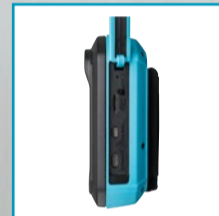
HDMI port k video výstupu, USB-C k nabíjení, micro SD
