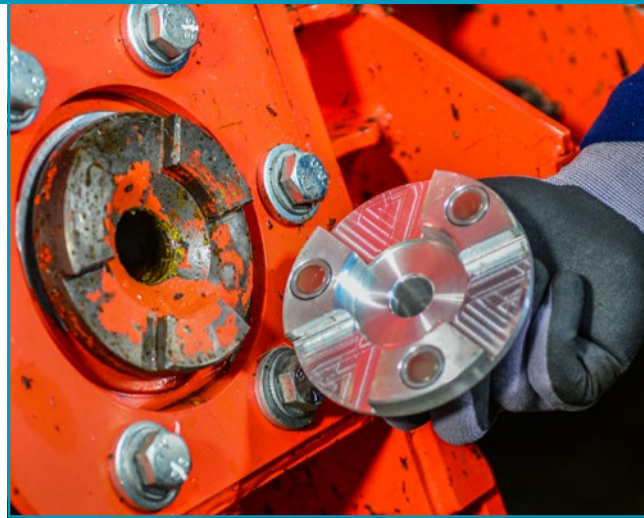
Nástroj s profilem vhodným k rychlospojce
